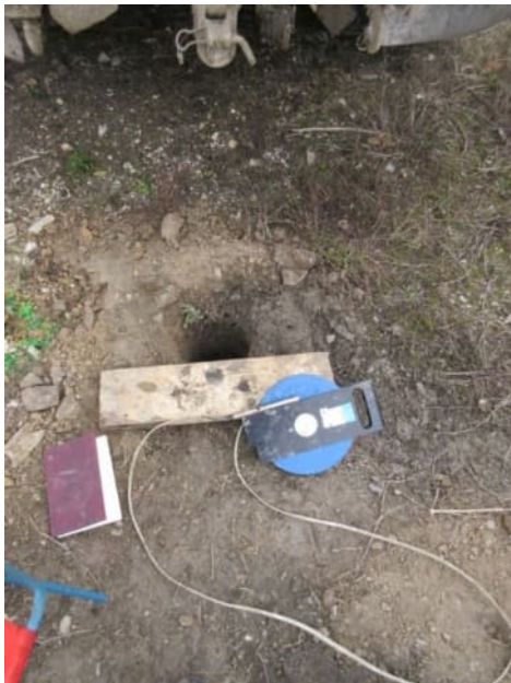
Obrázek PV1.5 Provádění vsakovací zkoušky na lokalitě - měření
