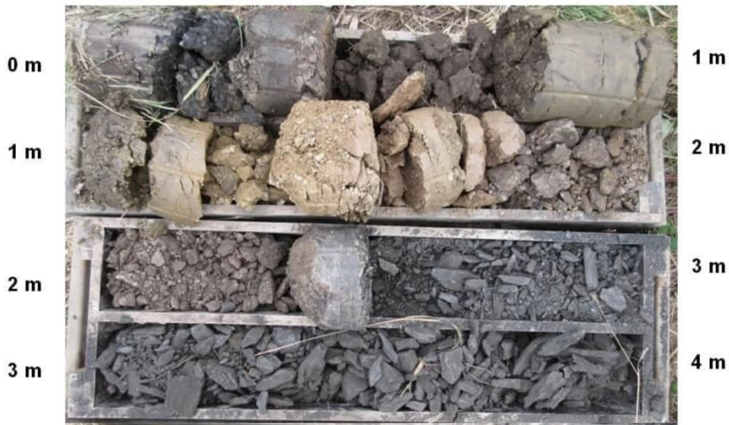
Obrázek PV3.3 Vrtné jádro v části 0 až 4 m
