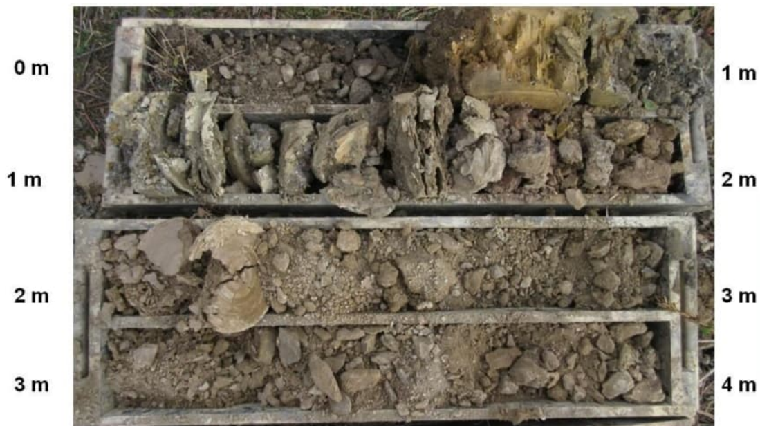
Obrázek PV1.3 Vrtné jádro v části 0 až 4 m
