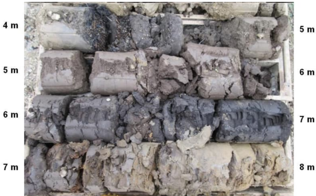
Obrázek PV5.3 Vrtné jádro v části 4 až 8 m
